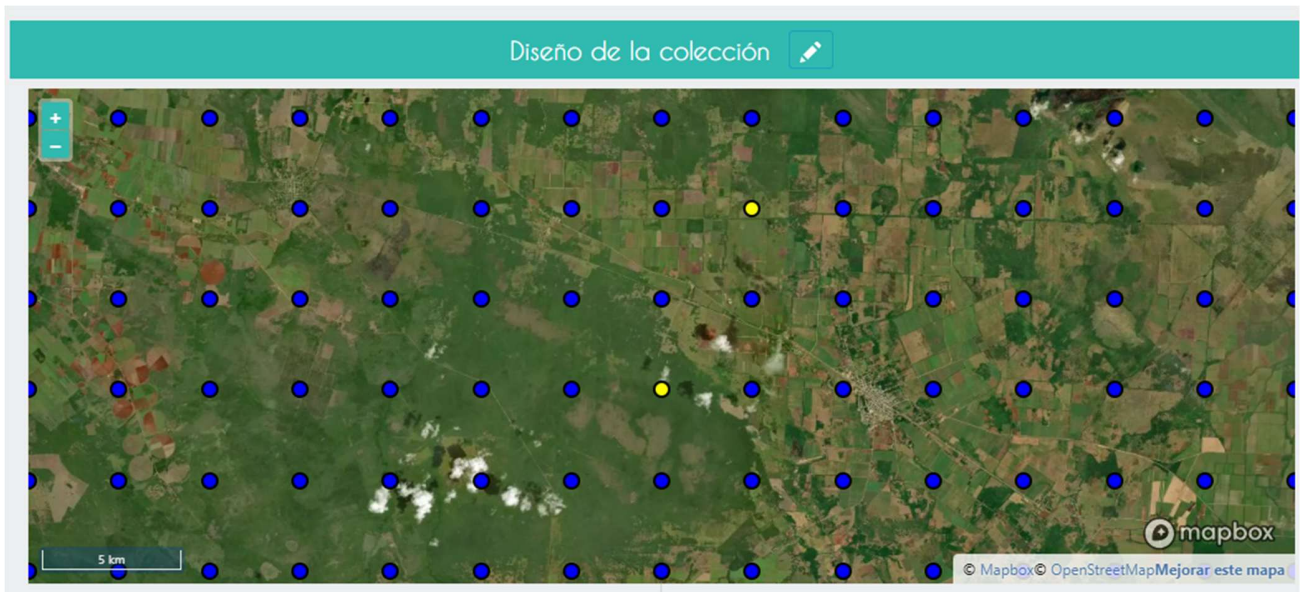
Figura 1: Distribución de las parcelas de muestra mediante grilla de punto obtenida en QGIS para un tamaño de muestra de 10 000 parcelas.
