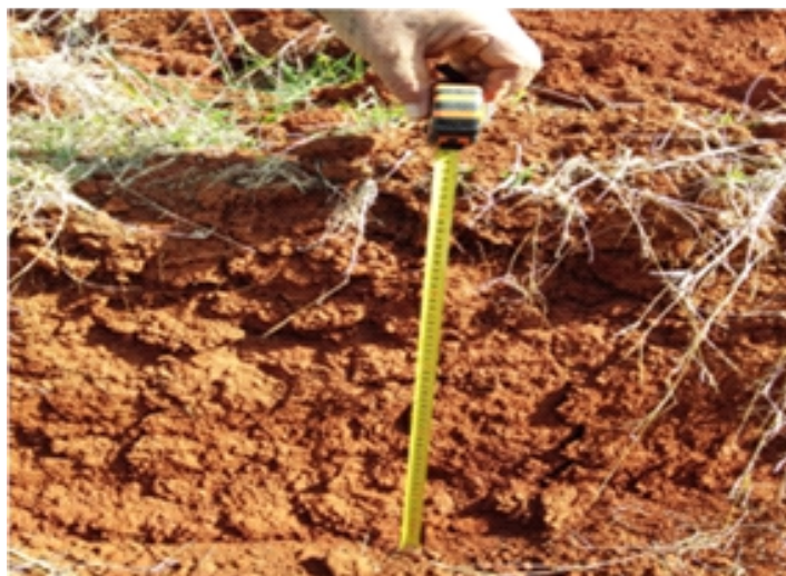
Midiendo las capas de un perfil del suelo para determinar la variación de la humedad con la profundidad.
