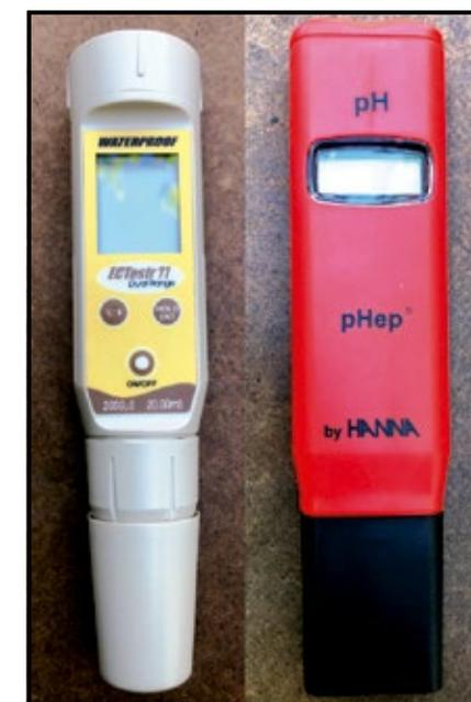
Instrumentos de medición: conductímetro y pHchímetro.
