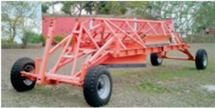
En Cuba se fabrican diversos tipos de equipos para el nivelado de los suelos, entre ellos el land plane .
